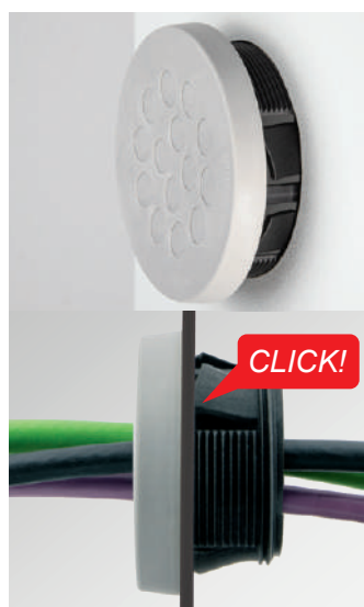
Sposób montażu 1: Zatrzasknij w wycięciu Do ścian o grubości 1 – 2,5 mm
