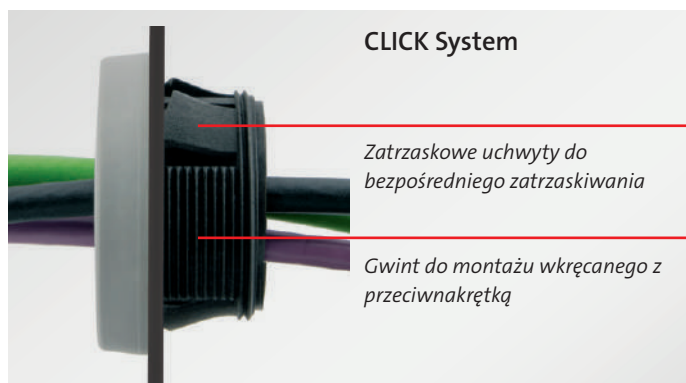
Sposób montażu 1: Zatrzasknij w wycięciu Do ścian o grubości 1 – 2,5 mm
