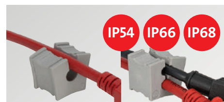
Gommini passacavo KT divisibili, per cavi precablati o senza connettore, per cavi di diametro fino a 35 mm
